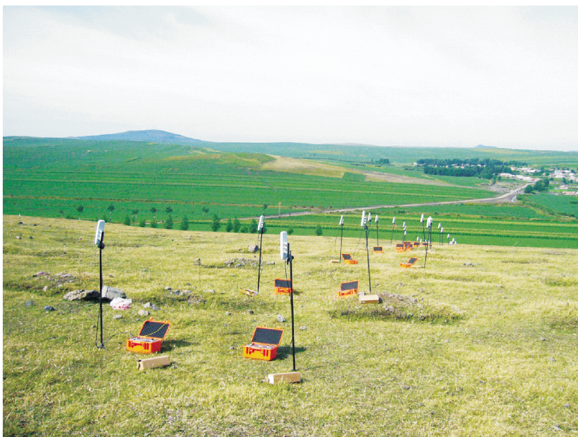
图 12 大庆油田三维广域电磁法勘探信号接收现场
